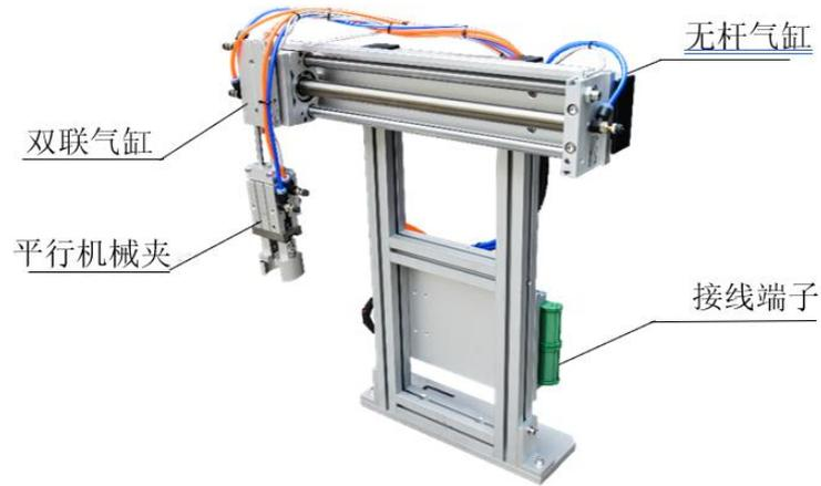
图 10 桁架搬运模块实物图
